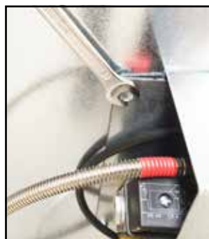
4 vijzen in de hoeken losschroeven (sleutel 8) Dévisser les 4 vis avec une clé de 8
