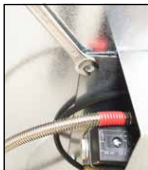
4 vijzen in de hoeken losschroeven (sleutel 8) Dévisser les 4 vis avec une clé de 8
